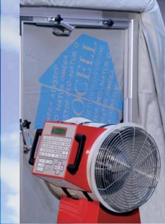
Lors du contrôle de l'étanchéité de l'enveloppe d'un bâtiment au moyen du procédé de mesure Blower Door, on réalise une dépressurisation dans un bâtiment étanchéifié. De cette façon, il est possible de déterminer et de supprimer sans trop d'efforts d'éventuels défauts d'étanchéité.
